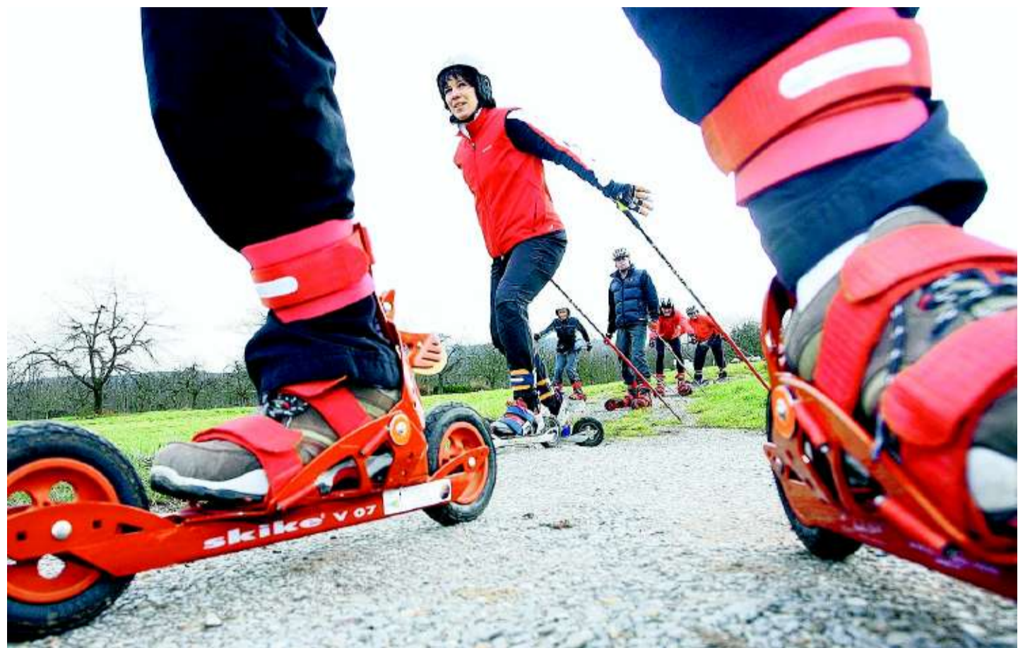
Skikes erinnern an Inline-Skater, allerdings haben sie luftgefüllte Reifen und eine Bremsvorrichtung.
